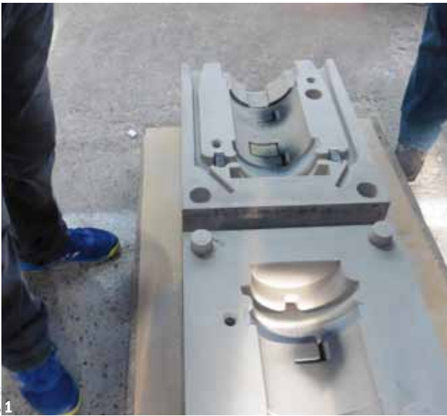
Un aperçu des procédés multitechnologiques : un moule de sable vert, une spécificité de Sival Group (photo 1) et un des fours de traitement thermique (photo 2).
